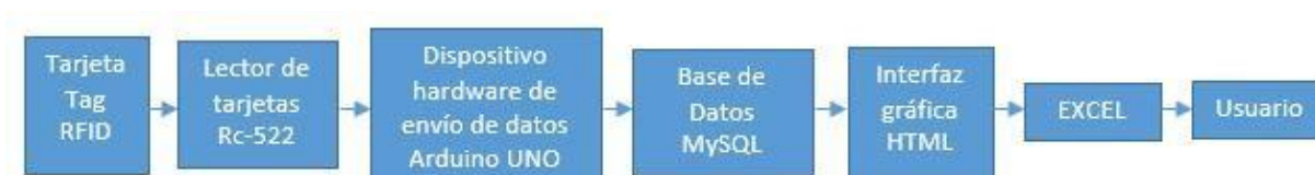
Figura 16. Esquema de diseño del sistema.
