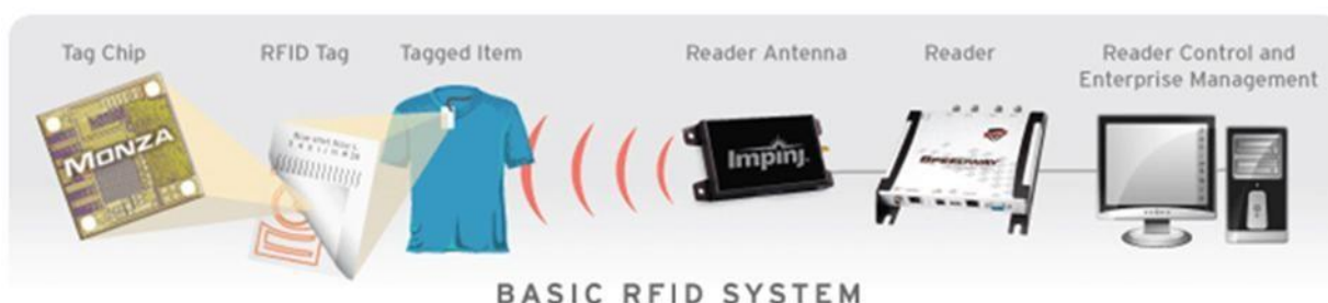
Figura 9. Elementos de un sistema RFID. Fuente: https://www.ears.com.ar/tecnologia-rfid/
