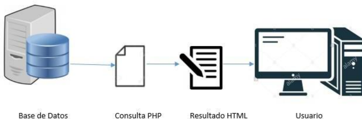
Figura 25. Funcionamiento de la Base de Datos con la interfaz gráfica.
